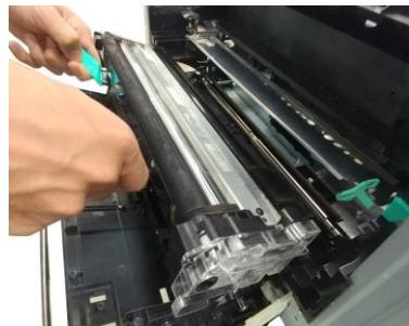
**7.** Аккуратно задвиньте блок проявки полностью в устройство до его фиксации (зашелкивания).
