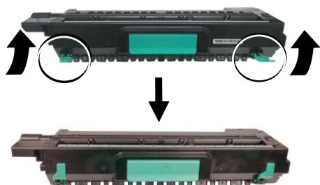
**4.** Возьмитесь за рукоятку драм-картриджа. Вставьте его горизонтально в отверстие в верхней части опорной рамы, как показано на рисунке.
