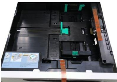
**4.** Снимите защитные ленты и пленку с верхней части устройства.
