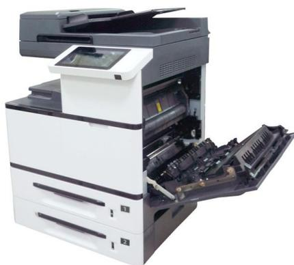
2. Поверните защелку направляющей бумаги по часовой стрелке, а затем нажмите на нее, чтобы зафиксировать направляющую бумаги.
