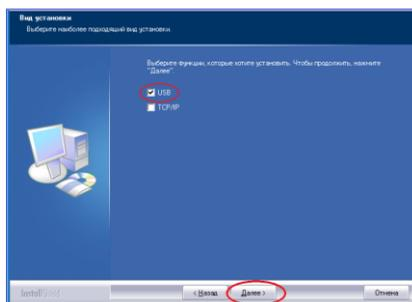
3. Когда появится диалоговое окно [Подключение устройства] с предложением включить МФУ и подключить его к компьютеру с помощью USB-кабеля, подключите один конец USB-кабеля к компьютеру, а другой к USB-порту устройства.
