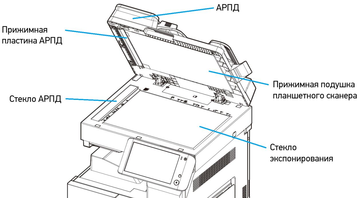
Смочите мягкую ткань водой или мягким чистящим средством, полностью отожмите ее, а затем очистите поверхности элементов области сканирования. После этого протрите поверхности очищенных элементов чистой сухой тканью.
