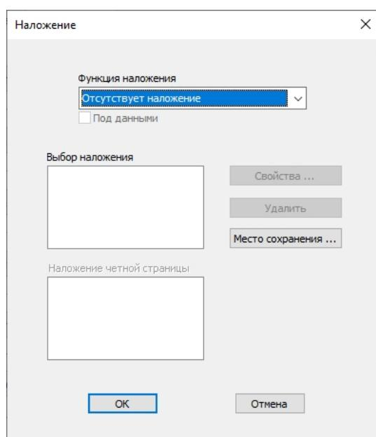
Вы можете напечатать непрозрачное фоновое изображение (наложение), которое может быть графическим, текстовым или смешанным. Наложение, по сути, представляет собой бланк-шаблон, сохраненный в компьютерном формате. Такие бланки-шаблоны часто используются в делопроизводстве для распечатки писем, коммерческих предложений, содержащих фирменный логотип или унифицированные поля. Вместо загрузки готовых типографских бланков можно использовать наложения.
