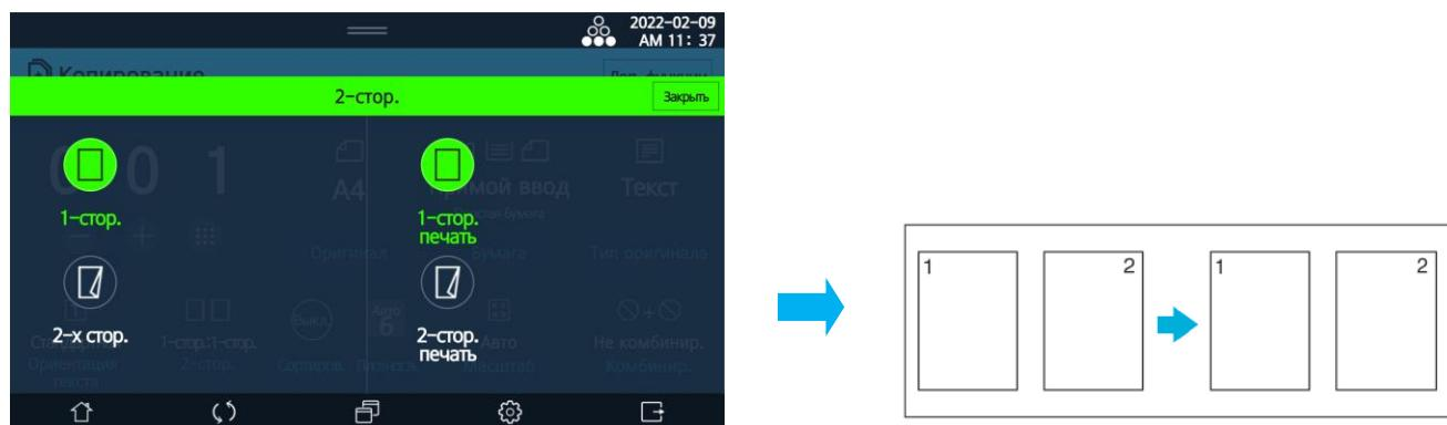
2. С односторонних оригиналов на двустороннюю копию при размещении слева направо
