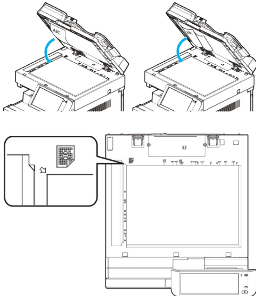
3 Используя ручку, аккуратно опустите крышку сканера (устройство АРПД), чтобы прижать оригинал к стеклу экспонирования для его равномерного прилегания.
