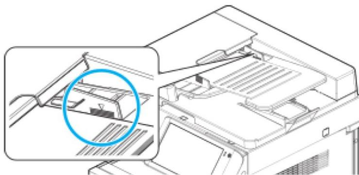
**3** Отрегулируйте направляющие оригиналов так, чтобы они соответствовали ширине оригинала.
