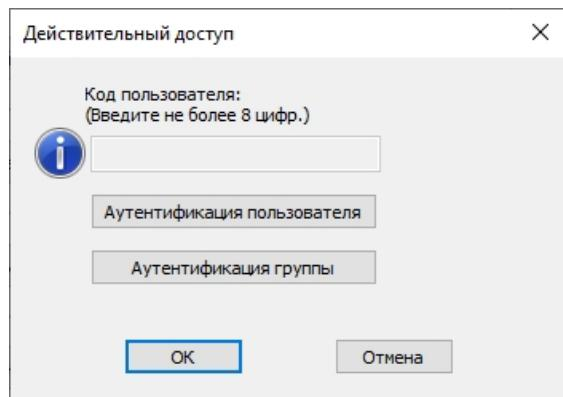
Используйте эту функцию для проверки кода пользователя или ограничения доступа неавторизованным пользователям.
