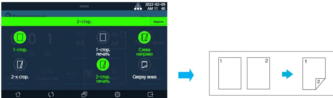
3. С двустороннего оригинала на двустороннюю копию при размещении слева направо
