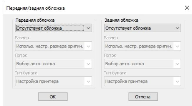
Для передней и задней обложек доступны следующие настройки: [Отсутствует обложка], [Пустая обложка], [Напечатанная обложка]. Также для передней и задней обложек можно выбрать [Размер], [Лоток] и [Тип бумаги].
