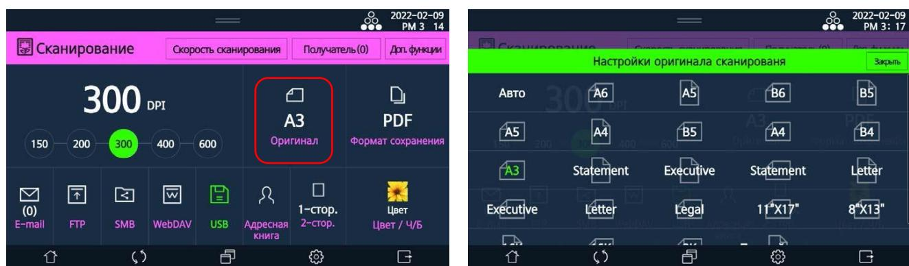
Б) Если оригинал имеет нестандартный формат, выберите [Прямой ввод], чтобы ввести размер оригинала вручную. Введите ширину и длину оригинала и нажмите [Закрыть].
