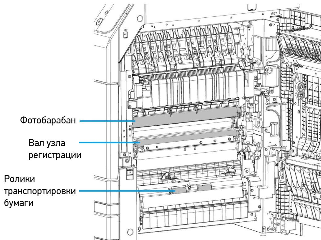
Очистку роликов производите в следующем порядке:
