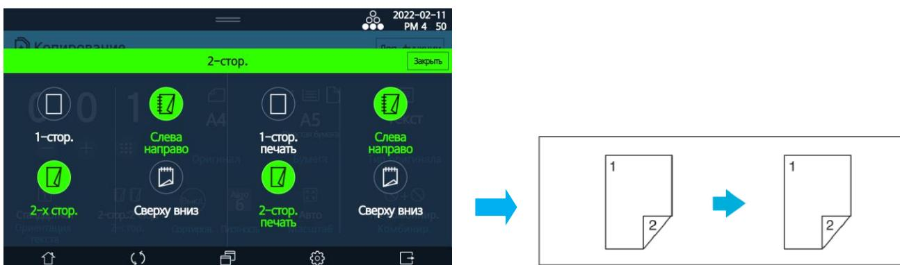
4. С двустороннего оригинала на одностороннюю копию при размещении слева направо
